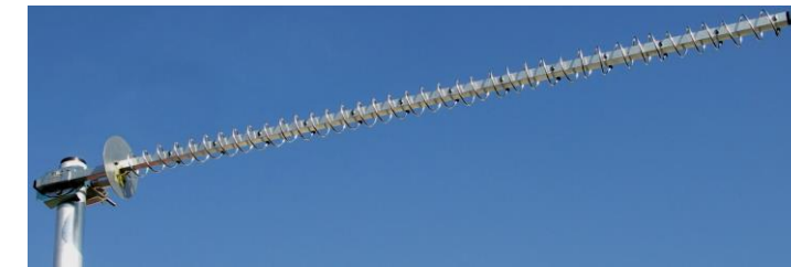
Antenne hélice 2,4GHz 40 spires 16dB RHCP
